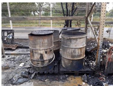
Exemples de fûts de piles bouton lithium issus d'étiquettes électroniques ayant pris feu
